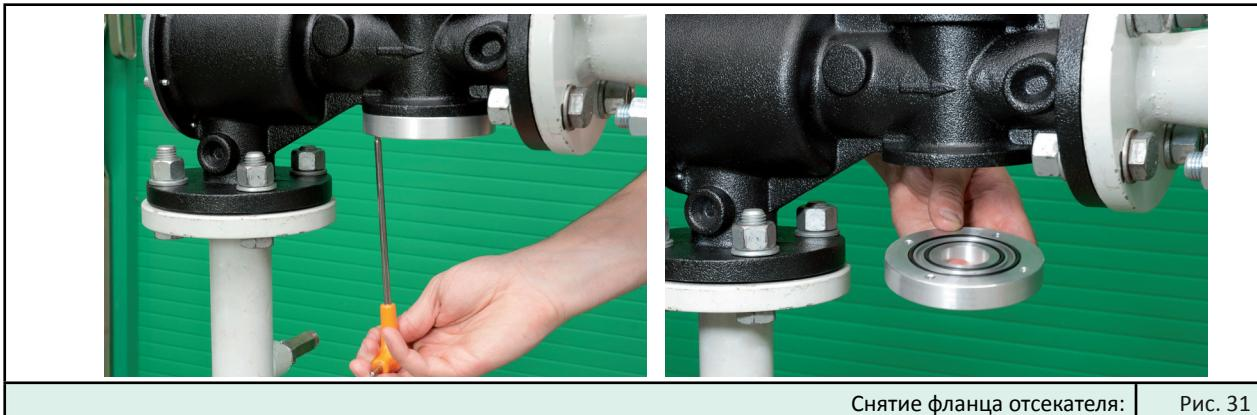
16. Открутить винты [48] и снять фланец [556]
