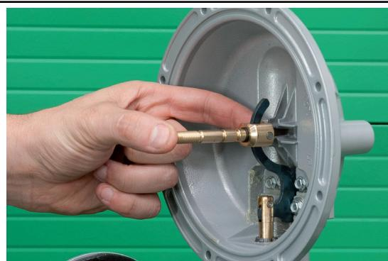
Проверка рычажных механизмов:
