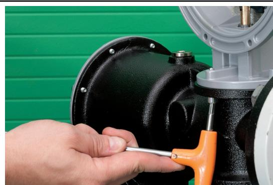
Откручивание винтов головки:
