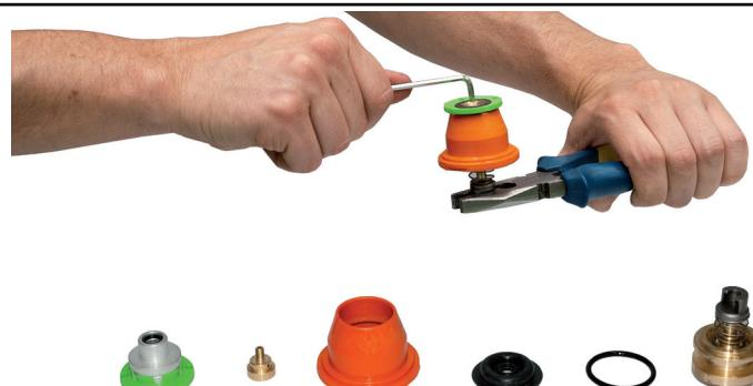
Разборка узла балансировки : Рис. 27
