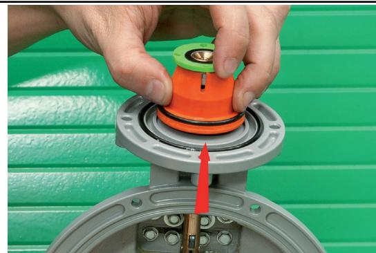
Извлечение узла балансировки : Рис. 26
