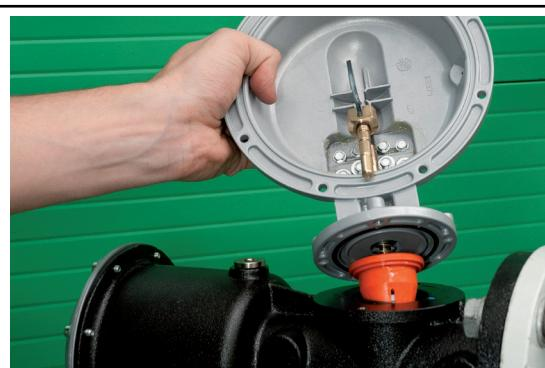
Снятие головки и узла балансировки:
